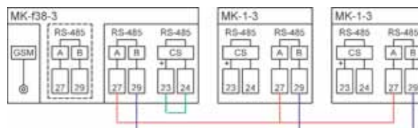
Esempio di collegamento multidrop su bus RS485
