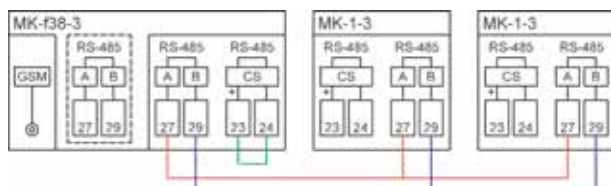
Esempio di collegamento multidrop su anello CS
