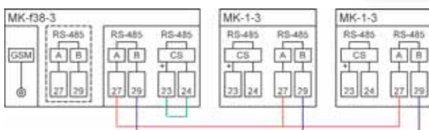
Esempio di collegamento multidrop su anello CS
